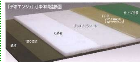
鋼板とFRPからなる耐圧壁の構造
