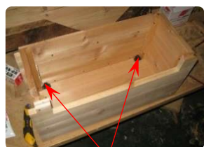
取出し口裏側に磁石取付け
