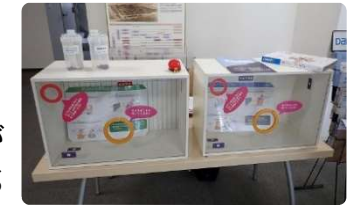
会場に用意された音響実験実演セット。中央に手を入れるための穴(オレンジ色)、左上に音を聞き取るための穴(赤色)がある。
