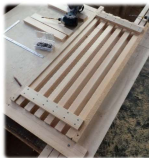
製作中：一枚大の型枠を作りその中に納めることで3枚同じ大きさに出来る。
