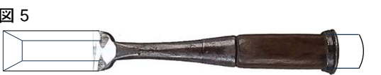
写真Aの1寸(約30mm)鑿。先代からのものでおそらく70年以上使用。残りは約2cm。柄も同様に消耗。
