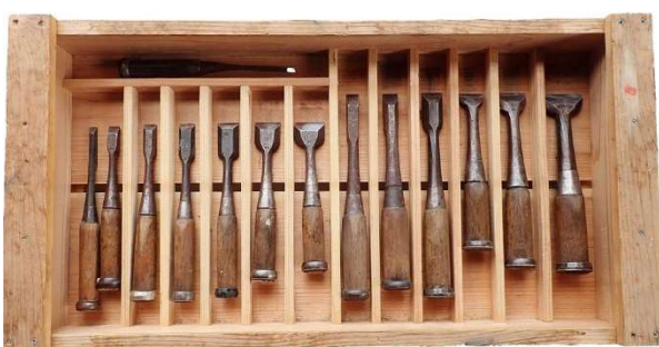
写真A：右から4本目（8分鑿）以外は、先代が使用していたものを受け継ぎ、現在使用している鑿。筆者が使用を始めて41年。普段使用するものだけでもこれだけ揃える必要がある。右6本が叩き鑿（骨組み等加工用）、左8本が大入鑿（造作加工用）。
